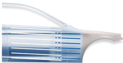
Standobluе Basecoat in einem Spritzgang bis zum Rand der Standobluе Color Blend 8570/8580 auftragen und in den angrenzenden Bereich / das angrenzende Teil ausweiten. Anschließend einen Effektgang in die nasse Standobluе Color Blend 8570/8580 beilackieren.
