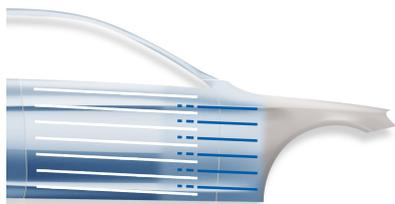
Aplicar 1 mano de Standoblue Basecoat hasta el borde de Standoblue Color blend 8570/8580 y degradar el color. Aplique una mano de efecto desde la zona de difuminado fundiendo con la capa húmeda de color Standoblue Color Blend 8570/8580.
