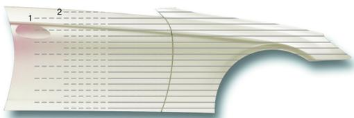
Applicare la tinta ad effetto Standohyd Plus sull'intero pannello nuovo e sfumare sulle zone adiacenti. Applicare la 1° mano sulla zona più grande e, se necessario, una 2°/3° mano con appassimento intermedio. Applicare dall'area più ampia, scalando la zona di sovrapposizione delle mani per evitare aloni/bordi e per nascondere la zona di transizione. Partire dalla zona più grande ed applicare verso il centro.
