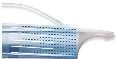
Sfumare il colore Standoblue Basecoat in una mano "leggera/ad effetto" al punto più lontano. Sfumare una seconda mano "leggera/ad effetto" del colore Standoblue Basecoat. Lavorare all'interno della mano precedente e verso il pannello riparato. Mantenere una distanza dal supporto durante l'applicazione. Durante la sfumatura, assicurare la sovrapposizione nel pannello riparato.
