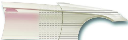
Fjern afdækningen og reducere sprøjetrykket til 0,5-1,0 bar og udsprøjt i de tilstødende panel. Afluft og gentage dette trin, hvis det er nødvendigt.
