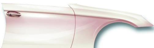
Efter grundig slutafluftning, før påføring af Standocryl klarlak.
