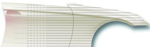
Påfør andet lag af effekten laget og sprøjt ud over kanten af det foregående lag og ind i det tilstødende panel. Brug dråbe teknik til udsprøjtning med reduceret tryk.
