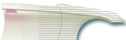
Slib udsprøjtningens området let med en pad grå for at fjerne oversprøjtning, hvis det er nødvendigt. Hvis det er nødvendig, påfør Standox Basecoat Colourless til det tilstødende panel. Påfør det første lag effekt farve på grundfarven og sprøjt ud over kanten af den tidligere påførte grundfarve i det tilstødende panel. Brug dråbe teknikken til udsprøjtningen. Afluft.
