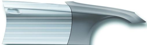
Påfør Standox Basecoat Colorless til tilstødende paneler
