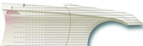
Påfør Standohyd Plus Basecoat effekt farve til den fuldstændige nye del og udjævn til de tilstødende dele. Sprøjt det første lag til det yderste område, hvis nødvendig påfør 2. og 3. lag med mellemmafluftning. Arbejde tilbage fra det bredeste område med forskudte overlappende effekt lag for at undgå en stærk hologram / synlig kant og giver en glat overgang. Start fra bredeste område og arbejde hen imod midten.
