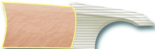
Afdæk de tilstødende paneler. Påfør Standohyd Plus Basecoat grundfarven på de nye paneler indtil fuldstændig dækning er opnået.
