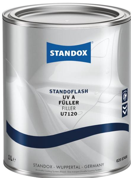
**Der Standoflash UV-A-Füller U7120 eignet sich für die Reparatur von kleinen Schadstellen wie Spot oder Micro Repair. Die extrem schnelle Trocknung wird mittels HID Quecksilber Lampen oder UV-A Licht emittierenden LED Lampen mit ausreichender Intensität im Wellenlängenbereich von 360-400 nm erreicht.**
