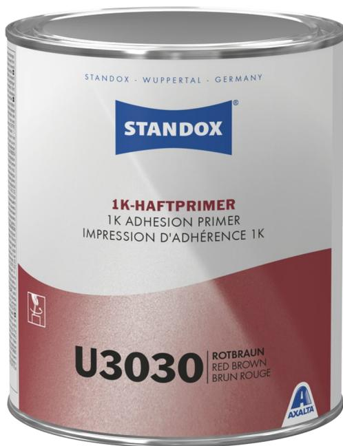
Standox 1K Adhesion Primer U3030 es una imprimación fosfatante 1K, libre de cromatos, que ofrece una mayor protección anticorrosiva y es fácil de aplicar. Se puede usar como imprimación en una sola pasada en piezas que están certificadas para soldadura. También se puede usar como imprimación debajo de aparejos imprimación 2K. Para reparaciones más pequeñas y en descubiertos del lijado, este promotor de adherencia está disponible en prácticos envases en spray (SprayMax).
