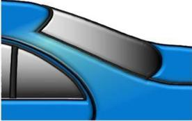
Pulir la zona de difuminado con un compuesto de pulido grueso y eliminar todos los residuos. Lijar la transición hasta la zona dañada con p.ej. Disco de Acabado Fino P3000 de 3M Trizact o un abrasivo similar de otra marca. Limpiar bien la zona lijada y pulida con Standox Precleaner 6800.
