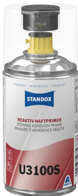
**Standox Primaire d'Adhérence Réactif U3100S est un primaire réactif 2K polyvalent, sans chromate, conçu pour la tôle d'acier, l'aluminium et les supports galvanisés. Il se mélange dans un rapport de 1:1 avec Standox Diluant Réactif U3110. Il est également disponible en bombe aérosol professionnelle pour les réparations rapides de petites zones.**
