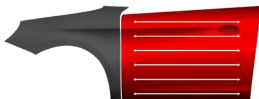
Preparare il pannello di riparazione e il pannello di miscelazione in base ai rispettivi TDS del Filler e alla qualità della base Standox in uso. Carteggiare lo stucco con P500-P600 meccanicamente. Carteggiare l'area di sfumatura con P1000-1200. Pulire bene la superficie prima dell'applicazione della rispettiva qualità del fondo Standox.
